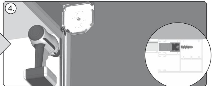
5. Das vormontierte Seitenprofil zuerst mit der Endkappe in den Kanal der Führungsschiene (1) einsetzen, danach das Profil bis zur Seite der Führungsschiene einschieben – sein oberer Teil muss sich ebenfalls in dem oberen Profil (2) befinden. Das vormontierte Seitenprofil mit der Wand (3,4) verschrauben.
