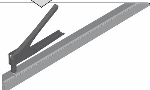
1. Mit einem 4,2 mm-Bohrer Montageöffnungen in einem Montagewinkel und der Oberschiene des Insektenschutzes anbohren. Die Öffnungen sollen je 50 cm gebohrt werden, nicht weniger als 3 im Profil. Danach den Montagewinkel mit der Schiene vernieten
