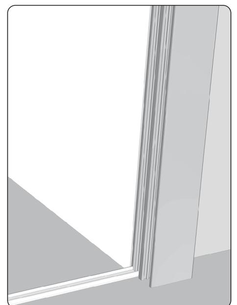
3. Die zwei Endleisten miteinander mit der Schnursperre (1) befestigen. Mit einem Band, das sich unterseitig an der Leiste befindet, die Endleisten mit dem Untergrund verkleben.
