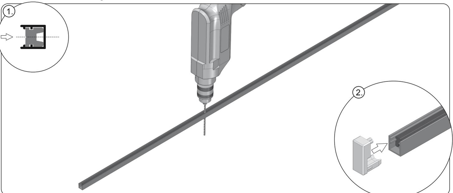
4. Montageöffnungen in dem Seitenprofil des Insektenschutzes mit einem 3,5 mm-Bohrer durch das Profil und den Magnet (1) anbohren. Die Öffnungen sollen je 50 cm gebohrt werden, nicht weniger als 3 im Profil. Den unteren Teil des Profils mit einer Endkappe (2) verschließen.
