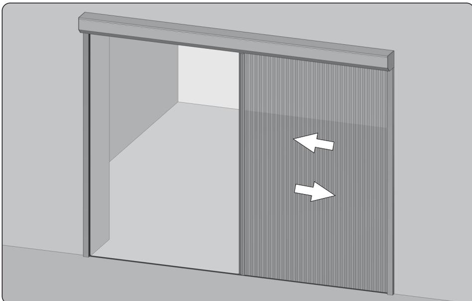
10. Überprüfen, ob der Insektenschutz ordnungsgemäß funktioniert. Bei deutlicher Schwergängigkeit sind die Spannschnüre gemäß Punkt 9 zu lösen. Das zweite Paket des Insektenschutzes an der gegenüberliegenden Seite in ähnlicher Weise wie das erste Paket montieren und dabei Punkte 4-9 beachten.
