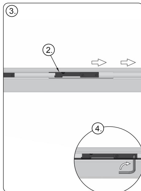
9. In dieselbe ausgefräste Öffnung (1) in der Oberschiene die zweite Sperre (2) einschieben, in die Richtung der gegenüberliegenden Seite als die erste (3) verschieben und dabei die Schnüre des Insektenschutzes anspannen. Die Sperre durch festziehen der Inbusschrauben (4) fixieren.
