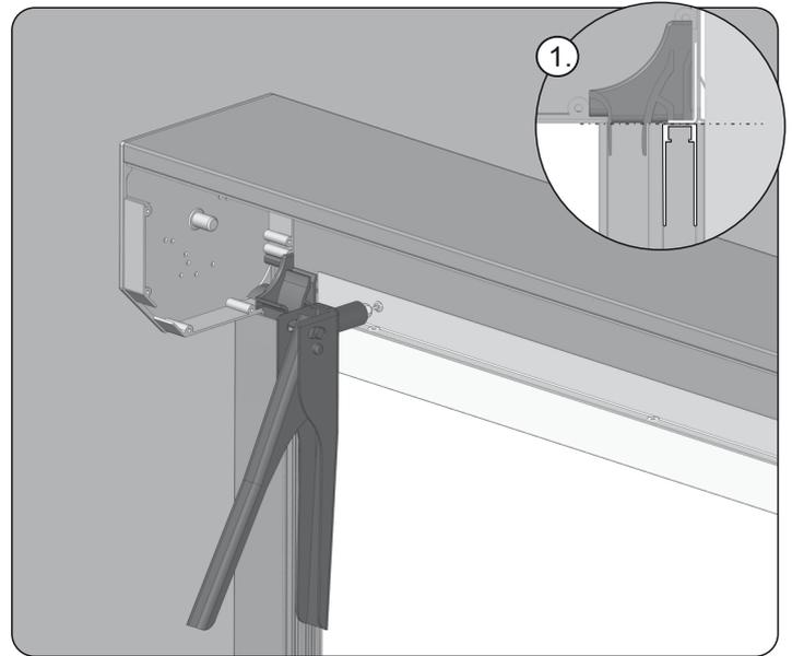
2. Die auf diese Weise vorbereitete Oberschiene des Insektenschutzes an der Innenseite des Rollladenkastens montieren. Dies soll auf so eine Weise ausgeführt werden, dass die obere Fläche der Schiene des Insektenschutzes mit dem oberen Ende der Führungsschiene des Insektenschutzes (1) bündig schließt. Mit einem 4,2 mm-Bohrer Öffnungen durch den Montagewinkel und den Rollladenkasten anbohren. Die Öffnungen sollen je 50 cm gebohrt werden, nicht weniger als 3 im Profil.
