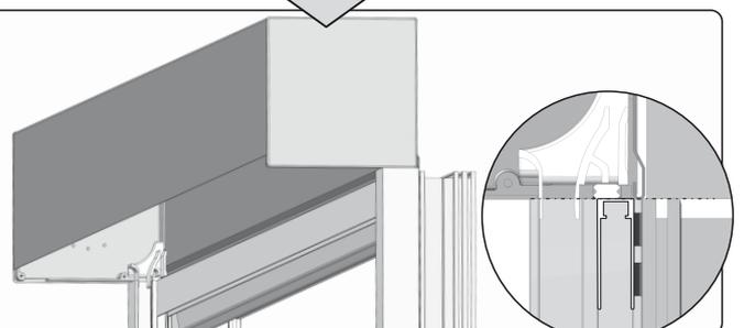
1a. Die Oberschiene des Insektenschutzes mit doppelseitigem Klebeband von der Innenseite des Kastens an dem Fensterrahmen befestigen, so dass die obere Fläche mit dem oberen Ende der Führungsschiene des Insektenschutzes bündig schließt.
