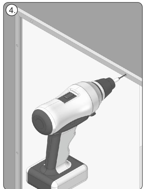
3. Den vorbereiteten Rahmen an dem Ort der Fassadenmontage (1) ausrichten. An der Wand die Stellen für die Montageöffnungen (2) markieren. Den Rahmen ablegen, die Öffnungen für Spreizdübel (3) bohren. Den Einbaurahmen anlegen und mit der Fassade (4) verschrauben.
