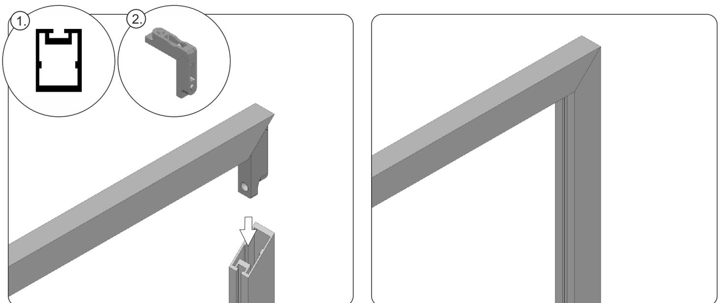
1. Aus den Profilen für die Frontmontage (1) und den Verbindern (2) den Einbaurahmen zusammensetzen.
