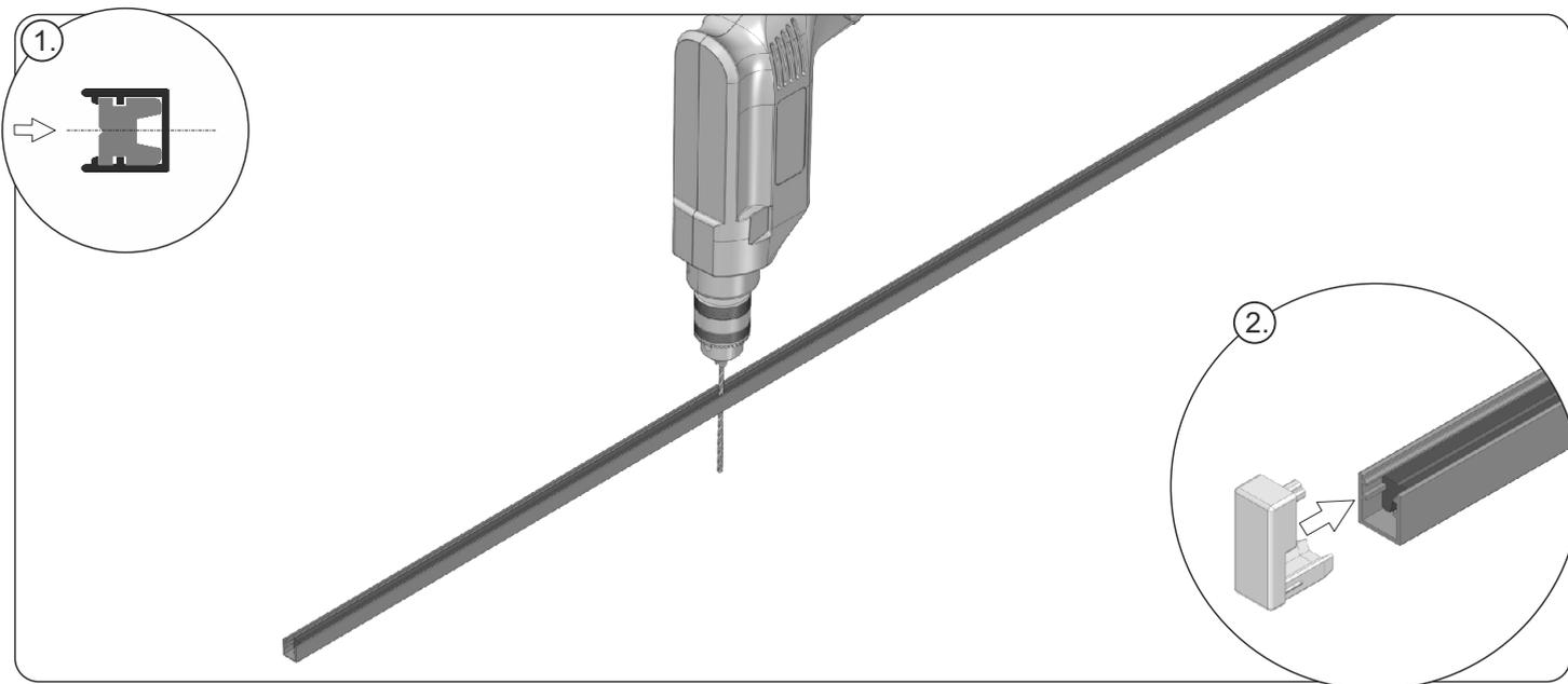
6. Montageöffnungen in dem Seitenprofil des Insektenschutzes mit einem 3,5 mm-Bohrer durch das Profil und den Magnet (1) anbohren. Die Öffnungen sollen je 50 cm gebohrt werden, nicht weniger als 3 im Profil. Den unteren Teil des Profils mit einer Endkappe (2) verschließen.
