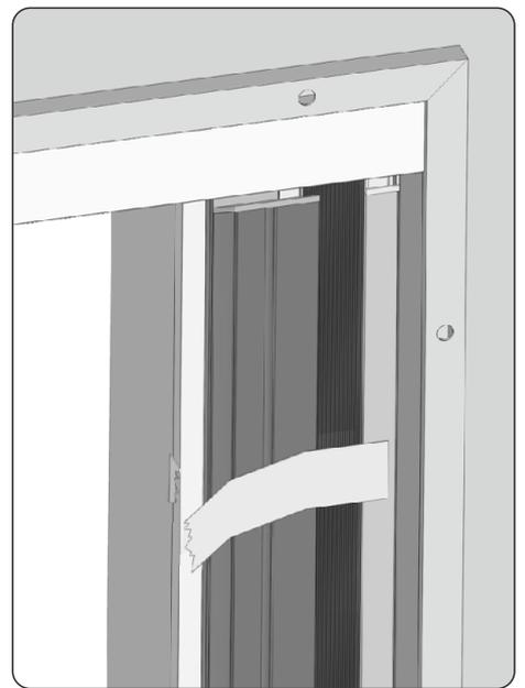
6. Das Insektenschutz-Paket montieren: zuerst den unteren Teil des Profils auf den herausragenden Bolzen in der unteren Endkappe des Seitenprofils aufschieben. Das Paket festhalten und das Befestigungsband des Insektenschutzes entfernen (Papierband).
