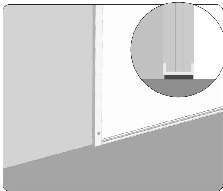
5. Mit einem Band, das sich unterseitig an der Leiste befindet, die Endleiste mit dem Untergrund verkleben.
