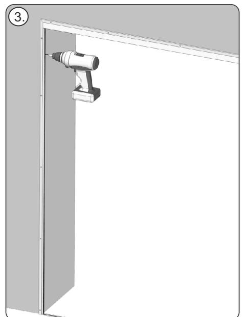
8. Den Magnet (1) lösen und aus dem Profil (2) herausziehen. Dann (ständig besonders auf die Schnüre des Insektenschutzes Acht geben, sodass sie nicht verwickelt oder verdreht sind!) das Profil mit dem Einbaurahmen (3) verschrauben.
