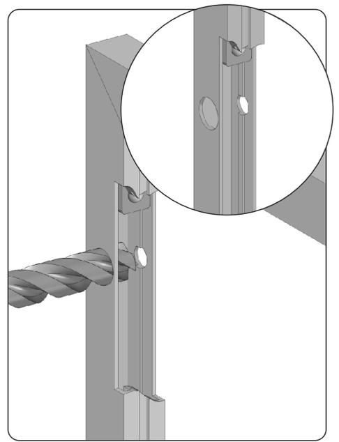
2. Montageöffnungen in den Profilen für die Frontmontage je 50 cm (mindestens 3 pro Profil) mit einem 4,2 mm-Bohrer durchgängig durch beide Wände des Profils bohren, danach mit einem 7,5-mm Bohrer in einer Wand die Bohrung vergrößern.
