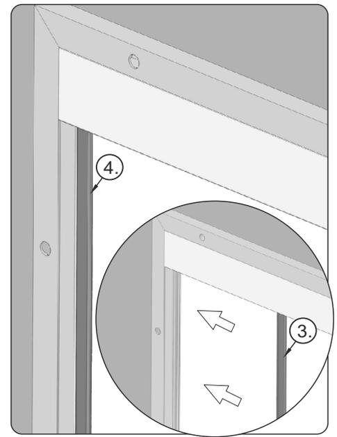
9. Die oberen (1) und unteren (2) Schnüre anspannen, um die Leichtgängigkeit des Insektenschutzes sicherstellen, ohne dass sich das laufende Gewebe ausschwenkt. Sobald die richtige Spannung erreicht ist, die Schraube mit einem Schraubenschlüssel festziehen. Den Magnet (3) im Profil (4) montieren.
