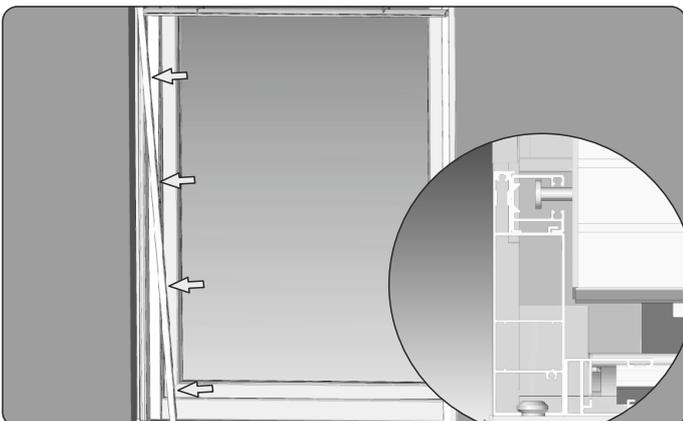
21. Die Führungsschienen in den Adapter seitlich einschieben.
