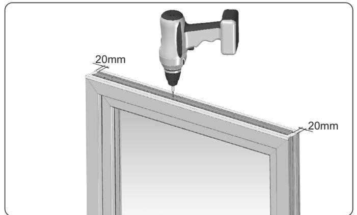
4. Das Anpassungsprofil samt der Aluminium-Einlage mit den Schrauben in den dazu vorgesehen Bohrungen an der Aluminium-Einlage des Profils so verschrauben, dass die Enden der Aluminium-Einlage von allen Kanten des Anpassungsprofils um den gleichen Wert von 20 mm entfernt sind.
