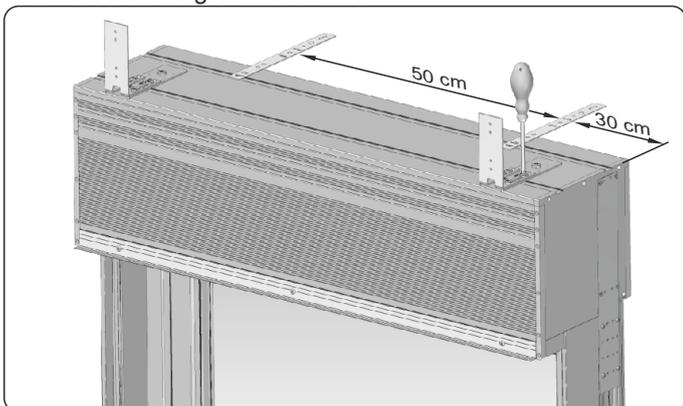
13. Die obere Verankerung in einem Abstand von 30 cm von den Rollladenkanten montieren und die beiden Elemente der Sturzhalter mit den im Lieferumfang enthaltenen Schrauben M5 verbinden und die Schrauben je nach Bedarf einstellen.
