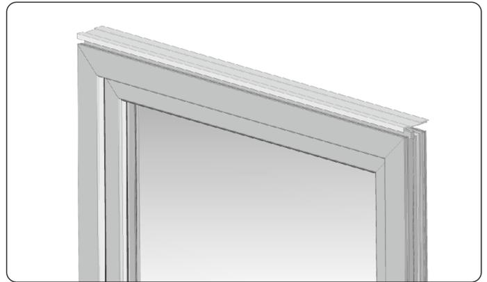
2. Das Anpassungsprofil auf den Fensterrahmen aufsetzen.
