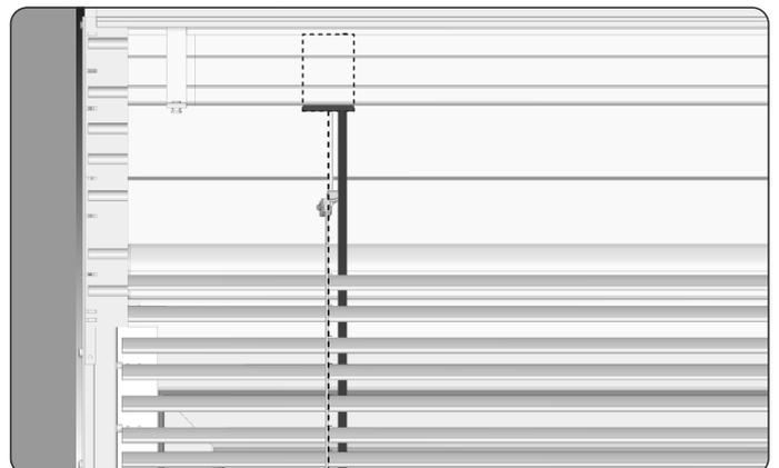
22. Prüfen, ob die Schnur mit dem Band vertikal in der Achse mit dem Lager in der Oberschiene ausgerichtet ist.
