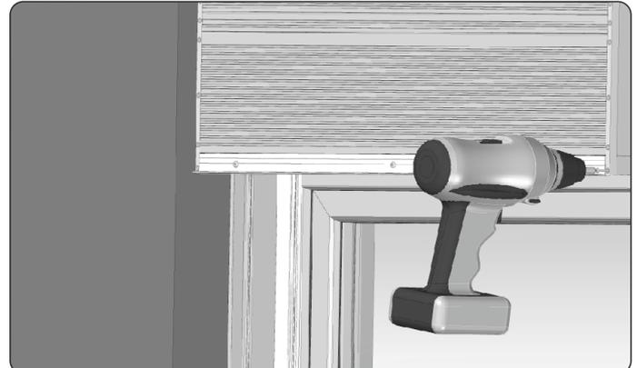
18. Die vordere Revisionsklappe abschrauben, um die Montage des Außenjalousien-Pakets zu erleichtern.
