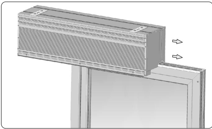
7. Den Kasten auf den entsprechend verschraubten Adapter stecken und bis zum Ende des Fensterrahmens einschieben. Nicht mit dem Hammer schlagen. Die seitlichen Kantenkanten müssen mit den seitlichen Fensterkanten flächenbündig sein.
