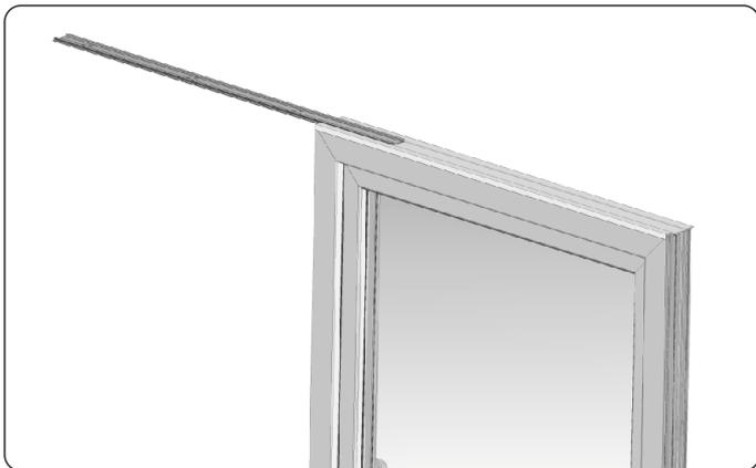
3. Die Aluminium-Einlage ins Anpassungsprofil einschieben.
