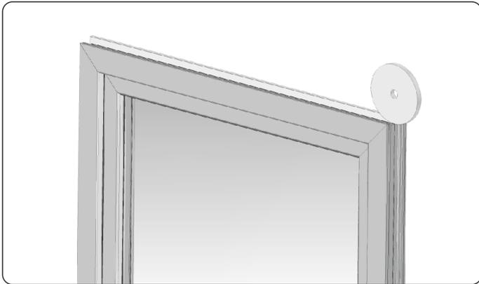
1. Vor der Montage des Adapters den Dehnungsband PURS STANDARD (der Dehnungsband wird von der Firma PORTOS nicht im Lieferumfang bereitgestellt – der Band ist im Angebot erhältlich) auf den Fensterrahmen aufkleben.
