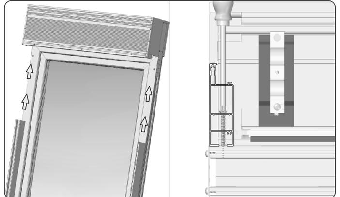
10. Den Adapter für Führungsschienen auf die zuvor am Fensterrahmen angeschraubten Befestigungsschrauben (Nippel) aufbringen oder optional mit den Schrauben verschrauben.
