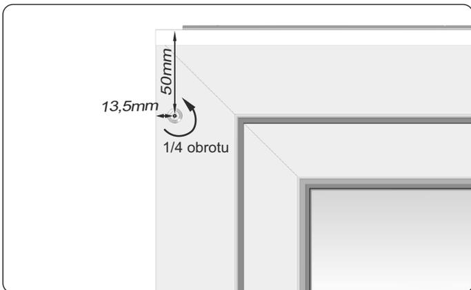
5. Anschraubpunkte von Befestigungsschrauben (Nippel) bestimmen, indem die oben genannten Abstände von den Rahmenkanten gemessen und markiert werden. Die Befestigungsschrauben (Nippel) für Führungsschienen an der markierten Stelle einschrauben. Sobald die Schraube angezogen wird, um 1/4 Drehung lösen, sodass die Führungsschiene leichter eingeschoben werden kann und die Verformung verhindert wird.
