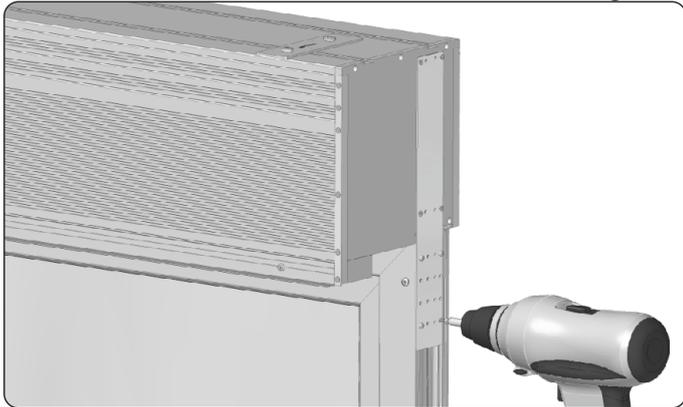
9. Die seitlichen Stahlhalter mit den Schrauben 3x6,5 mm (im Lieferumfang enthalten) in den dazu vorgesehenen Kastenbohrungen sowie ans Fensterrahmen anschrauben.
