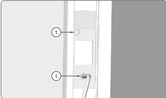
17. Falls erforderlich, die Höhe der Haken in den Führungsschienen einstellen, indem die Schrauben (1) gelöst und dann vorsichtig angezogen werden.
