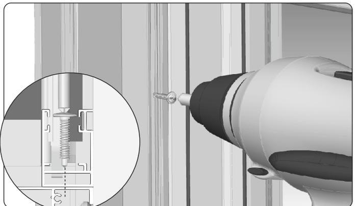
12. Anschließend die Führungsschienen für Insektenschutz mit den Schrauben 4,2x13 (im Lieferumfang enthalten) an den Adapter für Führungsschienen wie in der obigen Abbildung anzuschrauben – gilt für die Rollläden mit Insektenschutz.
