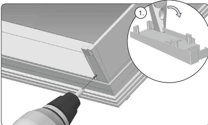
11. Untere Endkappen auf die Adapter für Führungsschienen aufsetzen und mit der im Lieferumfang enthaltenen Schraube 3x16 verschrauben. Für die Ausführung mit Insektenschutz vor der Aufsetzung die Wand in Endkappen wie in Abbildung 1 aufbrechen.
