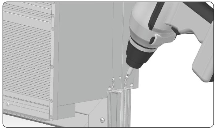
8. Sobald der Rollladen aufgebracht wird, die seitlichen Schrauben von der Außenseite des Rollladens her einschrauben.
