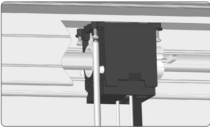
23. Befindet sich das Lager an der richtigen Stelle, ist es zu verschrauben. Wenn das Band von der Vertikalen abweicht, ist das Lager in der Oberrinne so zu verschieben, um die korrekte Ausrichtung des Bandes zu erreichen.
