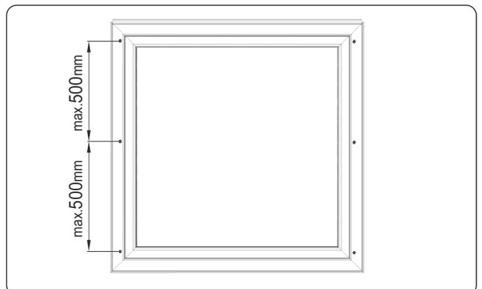
6. Die Befestigungsschrauben (Nippel) sollen durchschnittlich alle 50 cm, mindestens aber 3 Schrauben pro Seite und mindestens 5 cm von der Unter- und Oberkante des Fensterrahmens montiert werden.
