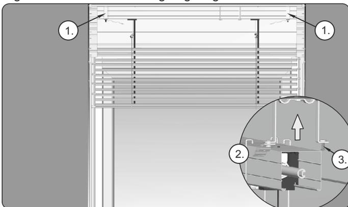
19. Das Jalousienpaket für einen kurzen Abstand absenken, um einen leichteren Zugang zur Anschraubung des Pakets in Montagegriffen (1) sicherzustellen, dann die Schiene des Jalousienpakets in die Griffe wie in der Abbildung 2 einschieben. Die Halter mit Schrauben (3) verschrauben.
