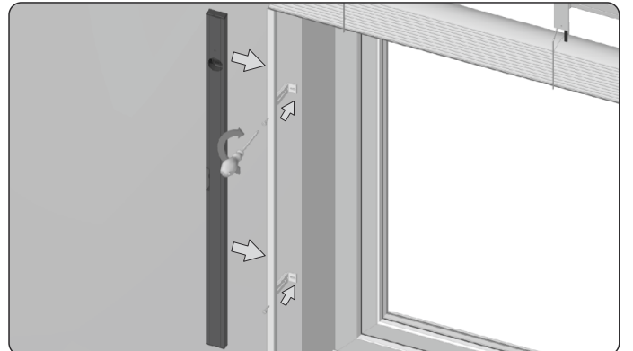
14. Anordnung der Führungsschienenachse genau abmessen, anschließend Führungsschienen an die Grundfläche anschrauben.
