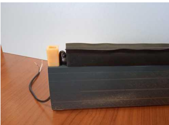
11. Ansicht des korrekt verschraubten Puffers und des an ihn herangeschobenen Widerstandssteckers.
