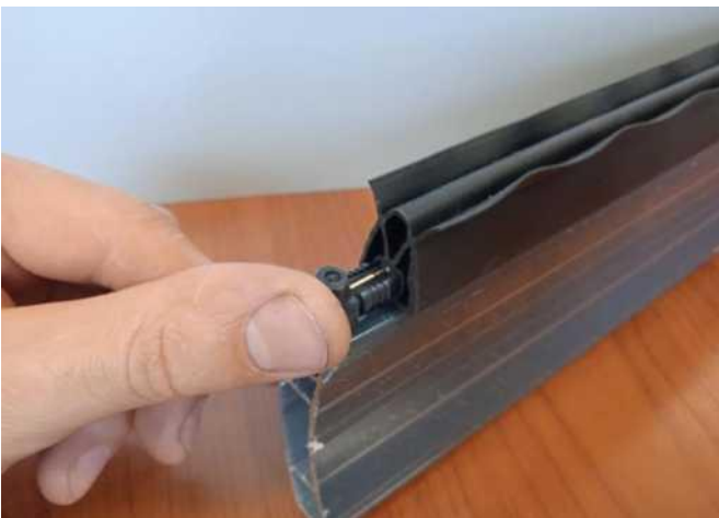
15. Stecken Sie den Stecker mit dem Widerstand wie gezeigt ein. Dies muss aufgrund des schnell trocknenden Klebers zügig erfolgen.
