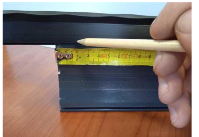
12. Messen Sie auf der anderen Seite der Endleiste 2 cm, beginnend vom Leistenende, und markieren Sie dies an der Widerstandsleiste.
