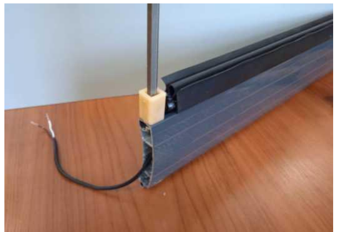
10. Schrauben Sie den Puffer mit einer Senkschraube 4x22 fest.
